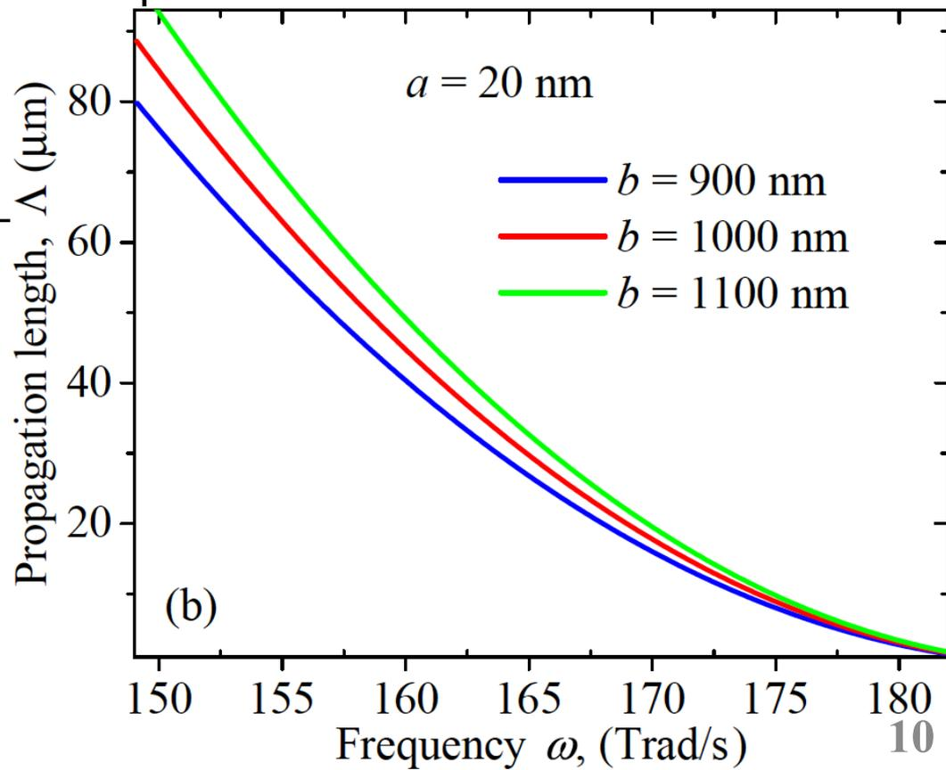
L'énergie de SPPs n'est pas modifié significativement pour la dispersion de taille des nanoparticules, si  $b \gg a$ .
